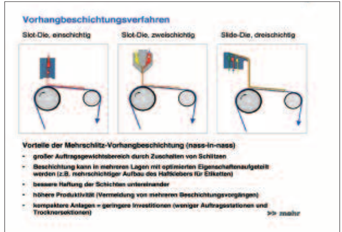
Die Firma Kroenert stellte verschiedene Vorhangbeschichtungsverfahren dar und erläuterte die Vorteile der Mehrschlitz-Vorhangbeschichtung (nass-in-nass)
